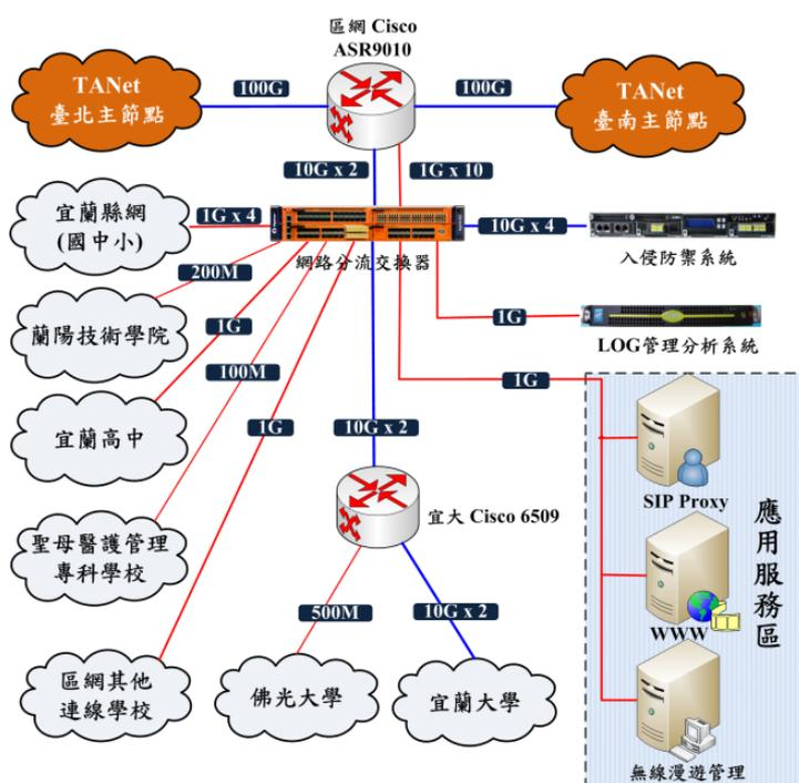
圖 19. 宜蘭區網中心架構示意圖
